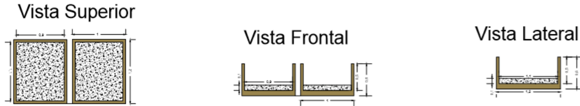
Ilustración 5 Lechos de Secado FUENTE: DGA ECOTAMBORES S.A.S
